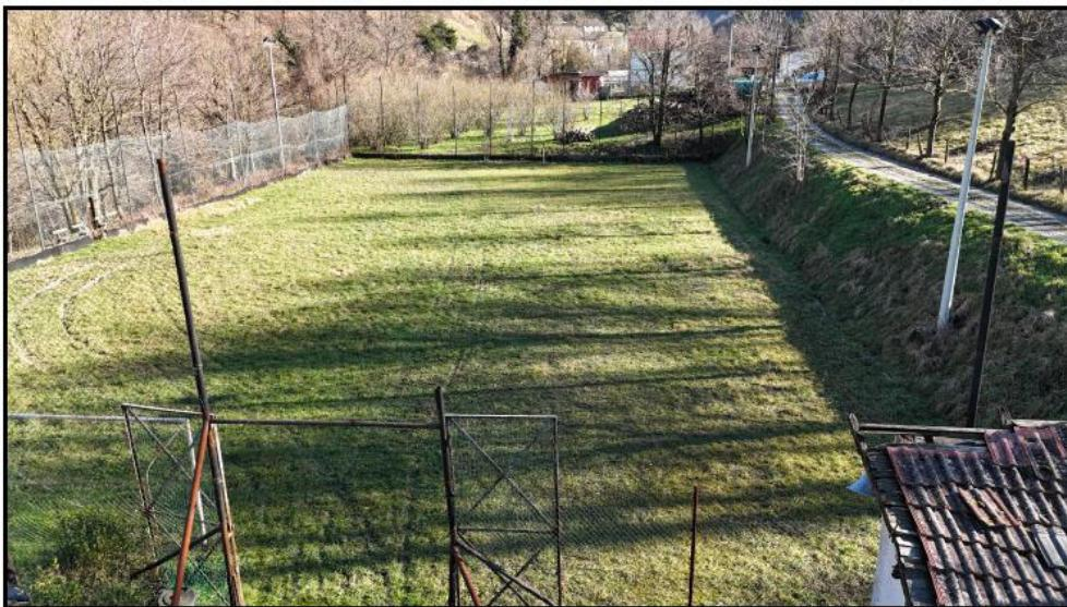
Esso risulta recintato in rete metallica posata, per tre lati, su un muretto in cls leggermente armato, mentre il quarto è protetto da una scarpata seminata a prato. Il campo è dotato di impianto di illuminazione ma mentre i pali sono in discrete condizioni, le armature e i collegamenti elettrici devono essere sostituiti. In prossimità dell'ingresso al campo esiste un piccolo fabbricato adibito a deposito la cui copertura è in parte crollata.
